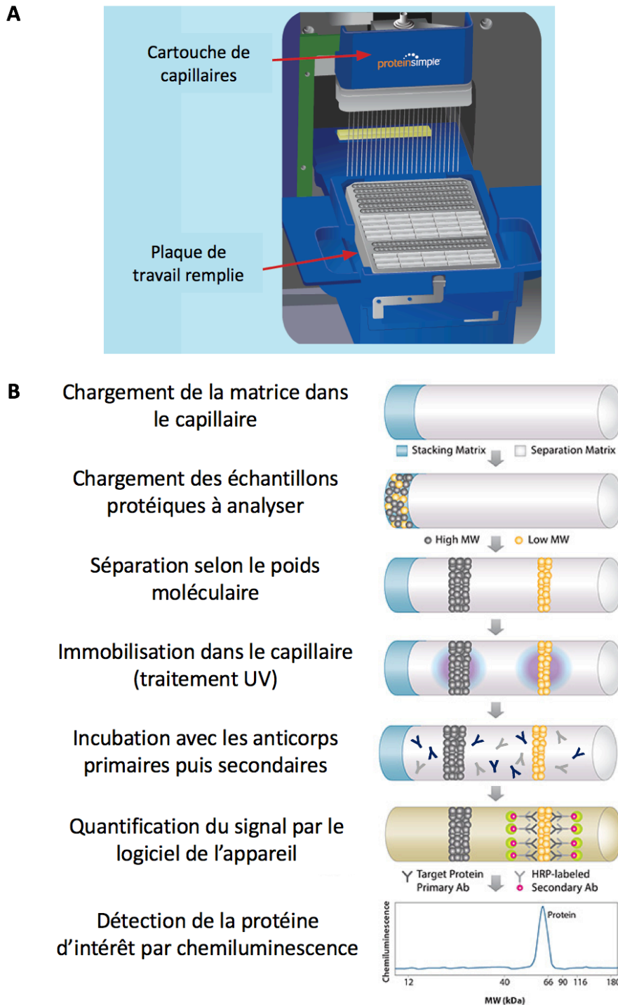
Figure 18 : Principe du Western Blot capillaire, réalisé grâce à l'automate JESS (ProteinSimple) de BioTechne. Les protéines sont aspirées dans le capillaire rempli de matrice et séparées en fonction de leur masse moléculaire sous l'effet d'un champ électrique. Elles sont ensuite immobilisées dans le capillaire grâce à un traitement aux rayons ultraviolets (UV), puis incubées en présence d'anticorps primaire dirigés contre la protéine à détecter, et enfin d'un anticorps secondaire couplé au système HRP, de façon à pouvoir cliver un substrat chemiluminescent dont l'intensité du signal sera dosée directement par l'appareil et correspond au taux d'expression de la protéine d'intérêt.
