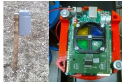
Figure 11 : A gauche, capteur Jasondark dans son support. A droite, carte électronique avec les capteurs TAOS TSL237
