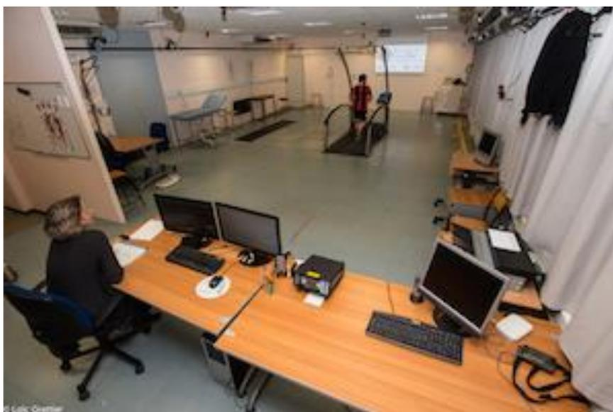
Figure 12 : grande salle de la PAM, au premier plan le poste d'enregistrement, au sol, entre les deux tapis noirs, les plateformes de forces.
