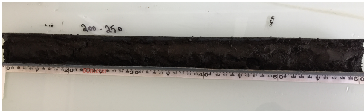
Fig.6. Section 200-250 cm de la carotte Mboro-Baobab montrant une sédimentation organique homogène.
