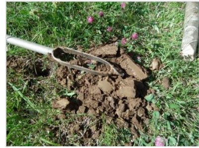
Figure 6 : extraction de sol à la tarière manuelle
