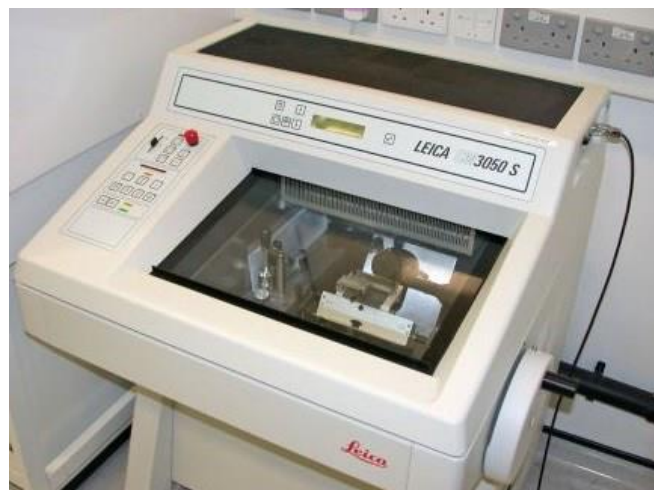
Figure 29: Cryomicrotome Leica CM3050 S.
