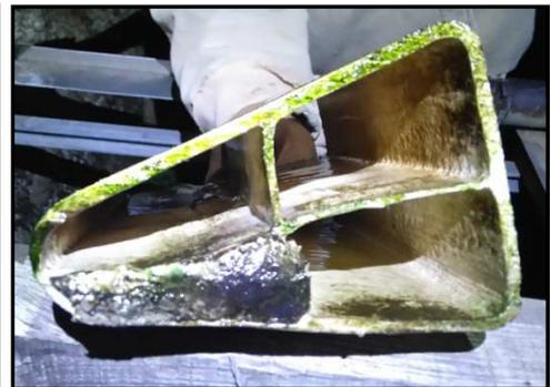
Photo 5 : Détail d'une cache alvéolaire, vue "en coupe", une des alvéoles est remplie de béton pour faire office de lest.
