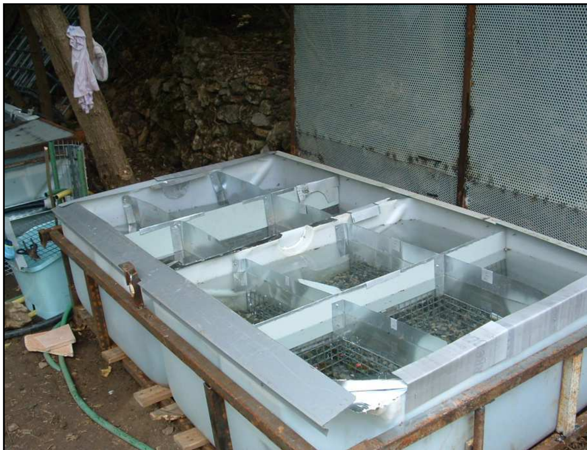
Photo 3 : Premiers bassins utilisés constitués de deux demi-cuves cloisonnées dans une caisse à couvercle.
