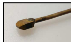
Photo 15 : Détail de la panne en laiton utilisée pour cryo-cautériser les pores génitaux des mâles P. leniusculus .
