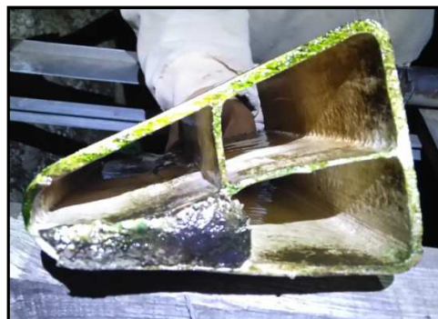
Photo 5 : Détail d'une cache alvéolaire, vue "en coupe", une des alvéoles est remplie de béton pour faire office de lest.
